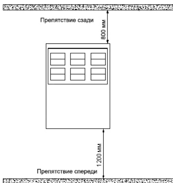
Рисунок 13 - Расстояние ИБП до перегородок.
