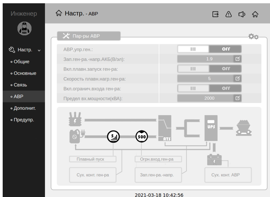
Рисунок 32 - Внешний вид страницы меню настроек АВР (Настройки работы с генератором)
