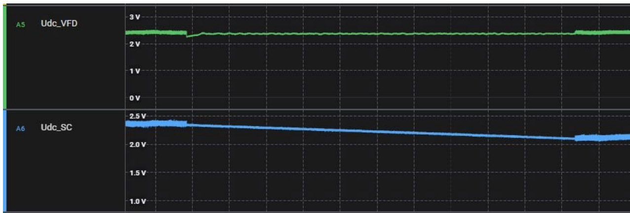
Рисунок 2 – Поддержание напряжения в звене постоянного тока при кратковременном прерывании напряжения с последующим восстановлением внешней сети.
